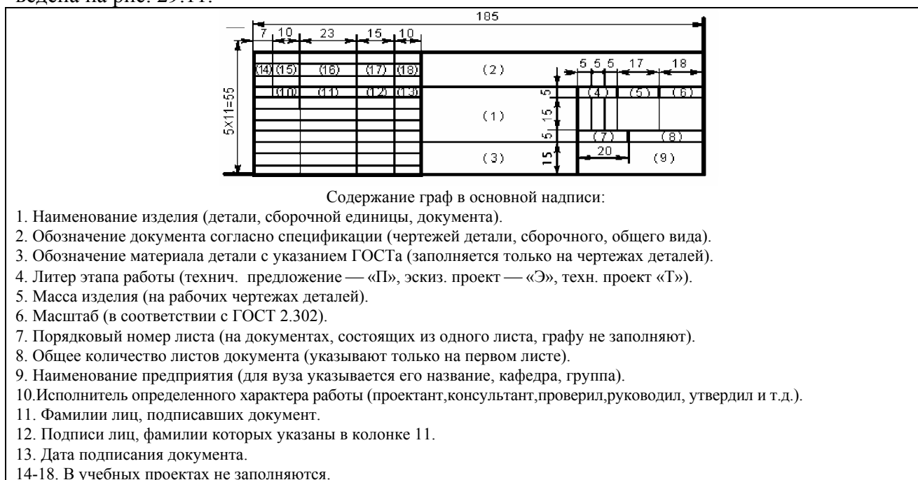
Рис. 29.8. Содержание граф и размеры основной надписи чертежа
